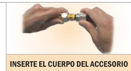
Utilice una llave expansiva para sostener el cuerpo del accesorio y otra para dar torque a la tuerca.
