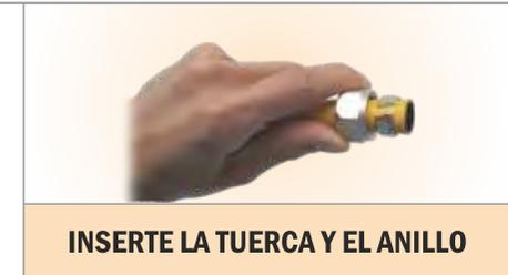
Verifique el buen estado de las puntas del emboquillador antes de usarlo, para evitar posibles daños en el tubo.
