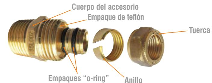
Los accesorios y válvulas para el sistema multicapa OKA PE AL PE y PEX AL PEX están especialmente diseñados para ofrecer resistencia a la corrosión, temperatura y presión. Dos empaques "o-ring" aseguran la estanqueidad entre el cuerpo del accesorio y la capa interna de polietileno del tubo. Al ajustar la tuerca al cuerpo del accesorio, el anillo produce una ondulación en la capa externa de polietileno del tubo asegurando una unión permanente.
