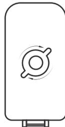
Cierre la caja de baterías, girando el seguro de la tapa en sentido de las manecillas del reloj.
